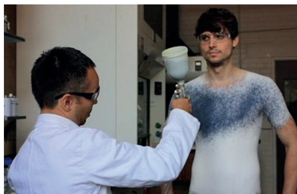
Рисунок 1 – Нанесение на тело человека нетканой ткани при помощи распылителя с добавлением различных красителей (рисунок адаптирован из Жидкая паутина: как работает технология одежды «из баллончика». URL: https://www.m24.ru/articles/nauka/03102022/507591 ; дата обращения: 16.09.2024)
