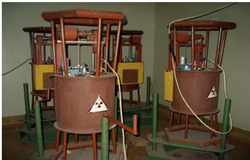
Рисунок 1 – Гамма-установка «Панорама» (фотография авторов) Figure 1: Gamma-ray facility «Panorama» (the photo is taken by the authors)
