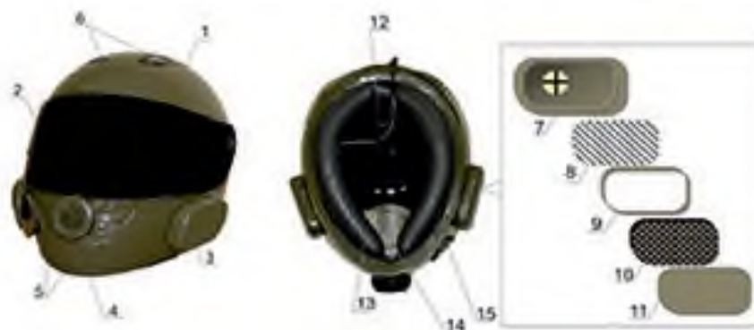
Рисунок 8 - Конструкция противогаза-бронешлема 2-го поколения (рисунок выполнен авторами): 1 - корпус бронешлема; 2 - защитное стекло; 3 - фильтрующе-поглощающие коробки с изолирующей полимерной крышкой-накладкой; 4 - клапан выдоха; 5 - нижние воздухозаборники; 6 - верхние воздухозаборники; 7 - гнездо ФПК с клапаном вдоха; 8 - нетканый материал; 9 - корпус фильтрующе-поглощающего элемента; 10 - фильтрующе-сорбирующий слой ФПЭ; 11 - изолирующая полимерная крышка-накладка ФПК; 12 - фильтрующе-сорбирующий слой в затылочной части шлема; 13 - пневматический obtюратор; 14 - подмасочник; 15 - приспособление для подключения к ФВУ
