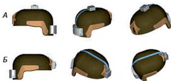
Рисунок 3 – Варианты размещения мультисенсорной системы на шлеме «Multicam». А – верхнее размещение; Б – размещение по директиве направления (рисунок подготовлен авторами по [5])
