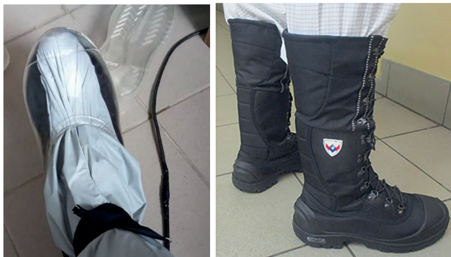
Рисунок 9 – Варианты использования бахилы со встроенной резиновой галошей (слева) и защитных сапог с противоскользящей поверхностью подошв из полиуретана и вспененного полиуретана с внутренним многослойным чулком (справа) (фотографии выполнены авторами)
