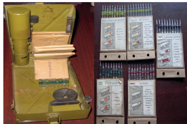
Рисунок 7 – Прибор химической разведки ПХР-46 (фотография из архива ФГКВООУВО «ВА РХБ защиты» Минобороны России)
