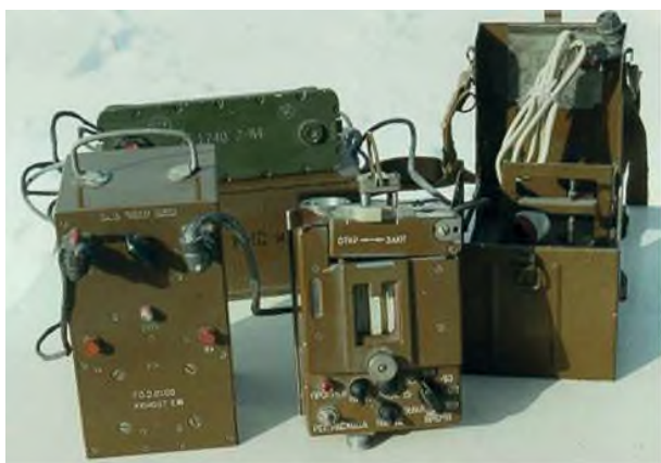
Рисунок 21 – Внешний вид автолаборатории ПХЛ-1 (фотография из архива ФГКВУОВО «ВА РХБ защиты» Минобороны России)
