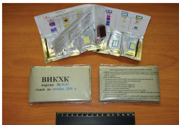
Рисунок 29 – Индивидуальное средство химического контроля (ИСХК) (фотография из архива ФГКВООУВО «ВА РХБ защиты» Минобороны России)
