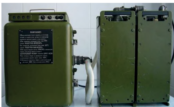
Рисунок 20 – Внешний вид прибора ГСА-12 с блоками питания БП-26 и БП-127/220 (фотография из архива ФГКВУОВО «ВА РХБ защиты» Минобороны России)
