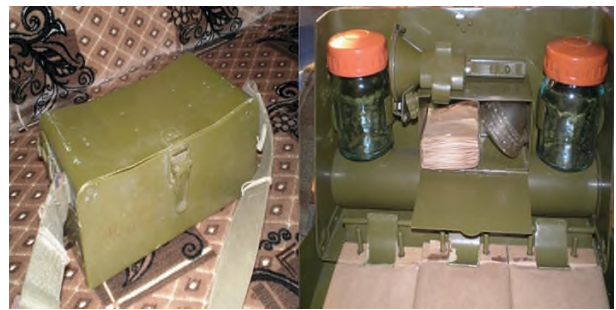
Рисунок 7 – Прибор химической разведки ПХР-46 (фотография из архива ФГКВООУВО «ВА РХБ защиты» Минобороны России)
