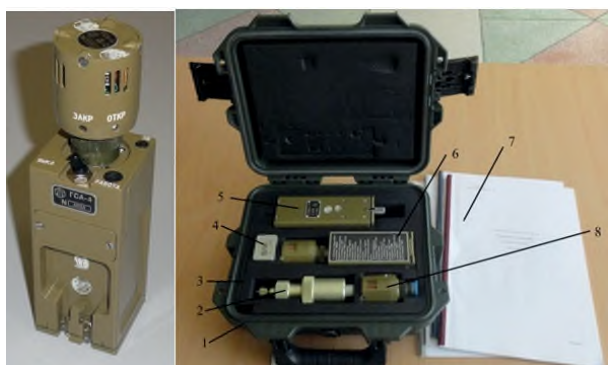
Рисунок 43 – Газосигнализатор автоматический ГСА-4 (фотография из архива ФГКВОУВО «ВА РХБ защиты» Минобороны России)
