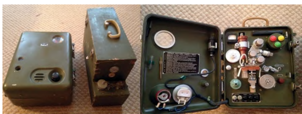
Рисунок 9 – Полевая химическая лаборатория ПХЛ-54 (фотография из архива ФГКВООУО «ВА РХБ защиты» Минобороны России)
