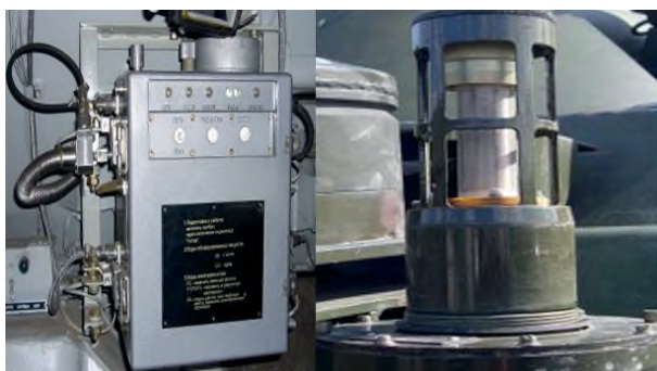
Рисунок 32 – Комплекс наземной дистанционной химической разведки КДХР-1Н «Даль» (фотография из архива ФГКВУОВО «ВА РХБ защиты» Минобороны России)
