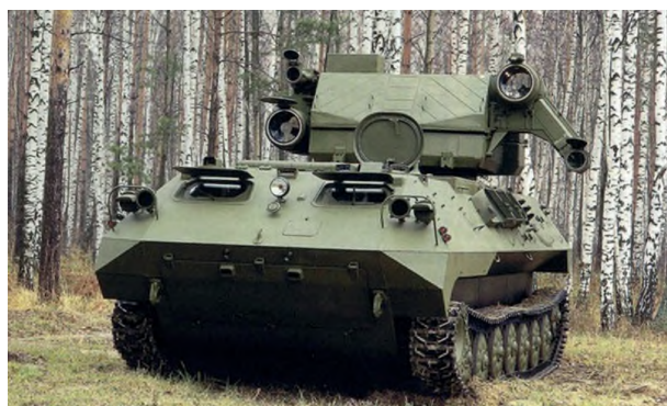
Рисунок 25 – Комплекс наземной дистанционной химической разведки КДХР-1Н «Даль» (фотография из архива ФГКВООУВО «ВА РХБ защиты» Минобороны России)
