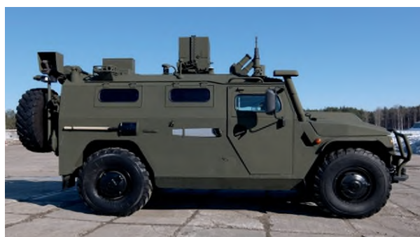
Рисунок 45 – Разведывательная химическая машина РХМ-8 (фотография из архива ФГКВОУВО «ВА РХБ защиты» Минобороны России)
