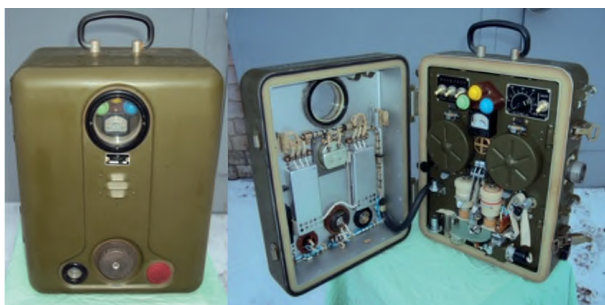
Рисунок 11 – Внешний вид газосигнализатора ГСП-11 (фотография из архива ФГКВУОВО «ВА РХБ защиты» Минобороны России)
