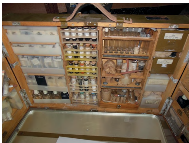
Рисунок 9 – Полевая химическая лаборатория ПХЛ-54 (фотография из архива ФГКВООУО «ВА РХБ защиты» Минобороны России)
