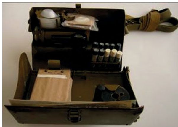
Рисунок 13 – Войсковой прибор химической разведки ВПХР (фотография из архива ФГКВУОВО «ВА РХБ защиты» Минобороны России)
