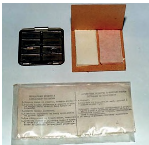
Рисунок 31 – Комплект химического контроля (КХК-2) (фотография из архива ФГКВООУВО «ВА РХБ защиты» Минобороны России)
