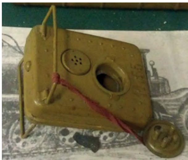
Рисунок 2 – Малый прибор химика-разведчика (насос-мех) из состава сумки химика-разведчика для работы с индикаторными трубками (фотография из архива ФГКВУОВО «ВА РХБ защиты» Минобороны России)
