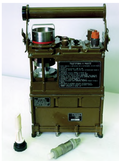
Рисунок 23 – Внешний вид сигнализатора ГСА-1 (фотография из архива ФГКВУОВО «ВА РХБ защиты» Минобороны России)
