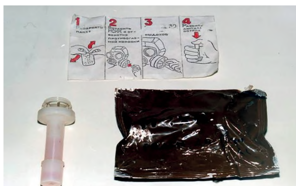
Рисунок 29 – Индивидуальное средство химического контроля (ИСХК) (фотография из архива ФГКВООУВО «ВА РХБ защиты» Минобороны России)
