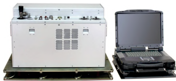
Рисунок 36 – Аналитический блок МХМС на амортизационной платформе и ПЭВМ (фотография из архива ФГКВООУО «ВА РХБ защиты» Минобороны России)
