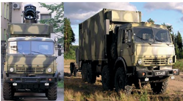
Рисунок 40 – Внешний вид многоцелевого подвижного комплекса дистанционной РХБ разведки КЛН-РХБР (фотография из архива ФГКВООУВО «ВА РХБ защиты» Минобороны России)
