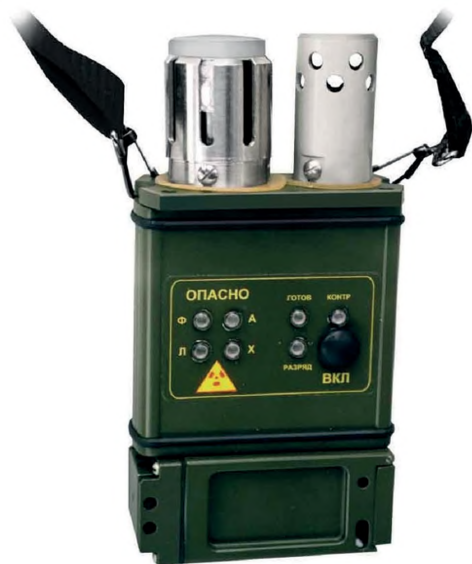
Рисунок 35 – Внешний вид ГСА-3 (фотография из архива ФГКВООУО «ВА РХБ защиты» Минобороны России)
