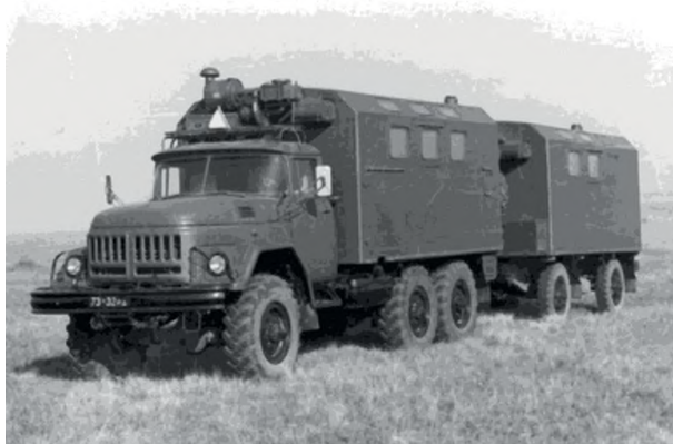
Рисунок 12 – Автомобильная радиометрическая и химическая лаборатория АЛ-4М (фотография из архива ФГКВУОВО «ВА РХБ защиты» Минобороны России)
