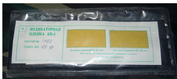
Рисунок 16 – Комплект индикаторных пленок АП-1 (фотография из архива ФГКВУВО «ВА РХБ защиты» Минобороны России)
