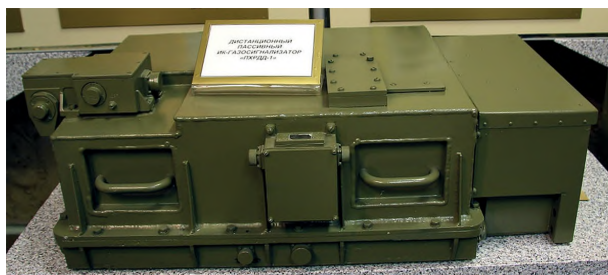
Рисунок 34 – Внешний вид прибора химической разведки дистанционного действия ПХРДД-1 (URL: http://www.vitalyukuzmin.net/Military/RKhBZ-Troops/i-fH3XZQC/ ; дата обращения:19.11.2023 г.)
