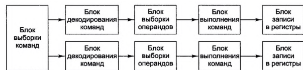
Рисунок 3 – Схема суперскалярной архитектуры с двумя конвейерами
