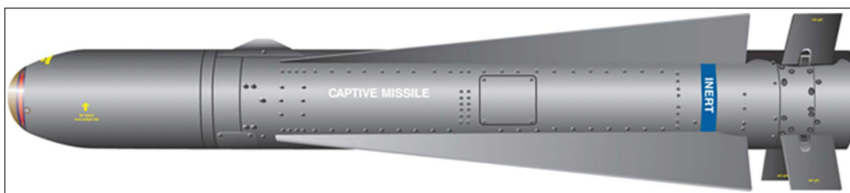
Рисунок 4 – Основной убийца танков в ходе ирако-кувейтского конфликта 1991 г. – AGM-65 Maverick – ракета класса «воздух–земля». Предназначена для непосредственной поддержки с воздуха. Это наиболее широко производимая высокоточная управляемая ракета в западном мире. Масса – 210–304 кг. Длина – 249 см. Диаметр – 30 см. Кумулятивный заряд WDU-20/B – 57 кг. Наведение лазерное инфракрасное и электронно-оптическое. Дальность полета ракеты – более 22 км (URL: https://translated.turbopages.org/proxy_u/en-ru.ru.e9edede2-6460e3bb-19a44cff-74722d776562/https/en.wikipedia.org/wiki/AGM-65_Maverick ; дата обращения: 12.02.2023)
