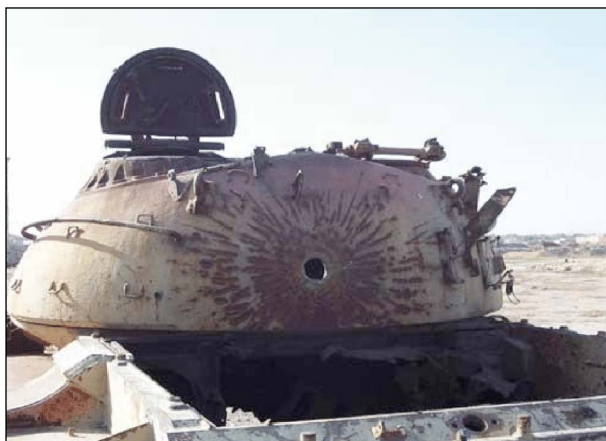
Рисунок 1 – Отверстие в башне иракского танка, образовавшееся после попадания снаряда с сердечником из DU [25]
