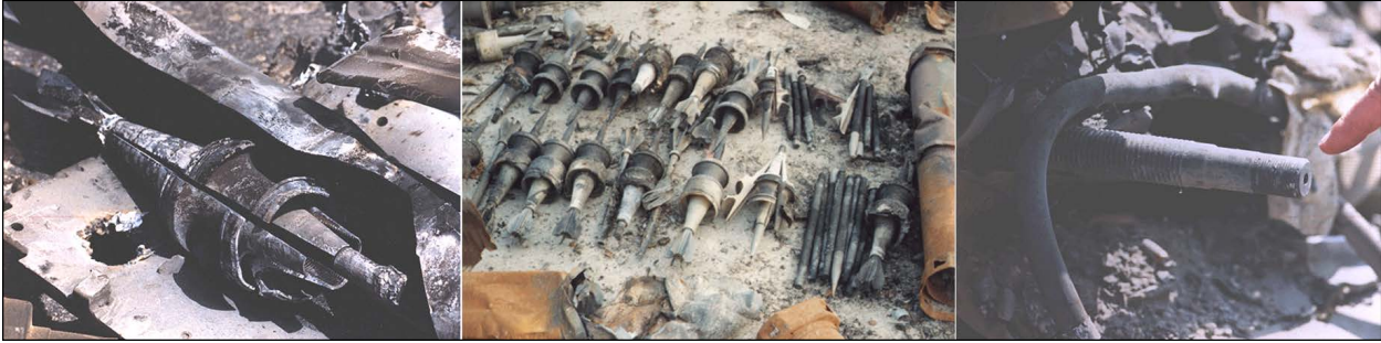
Рисунок 6 – Уничтоженные пожаром снаряды M829A1 с пенетраторами из DU. Многие из снарядов перенесли пожар без взрыва или сгорания. На снимках показаны поврежденные огнем снаряды M829A1 DU, извлеченные из прицепов и морских контейнеров CONEX. Hills A. The Doha Disaster, «The Doha Dash». См. URL: https://tanks-encyclopedia.com/the-doha-disaster-aka-the-doha-dash/ (дата обращения: 20.01.2023)
