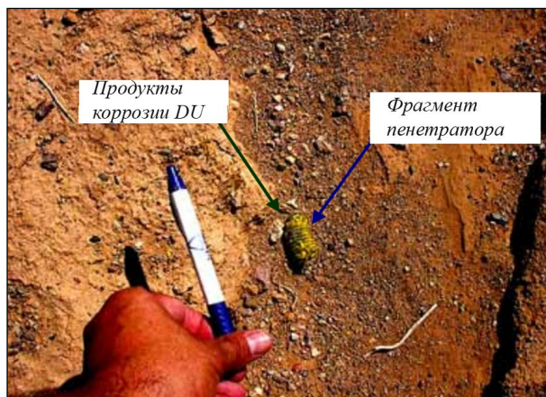
Рисунок 5 – Фрагмент разбившегося пенетратора из DU в почве Испытательного полигона Юма (Yuma Proving Ground, YPG) в Западной Аризоне. Характерный вид: тонкий стержень (немного толще авторучки), покрытый желтыми продуктами коррозии DU. Желтый цвет ему придают шозэпит и меташозэпит – гидратированные оксиды урана(VI). Благодаря примеси титана, коррозия развивается локальными участками на поверхности пенетратора [28]
