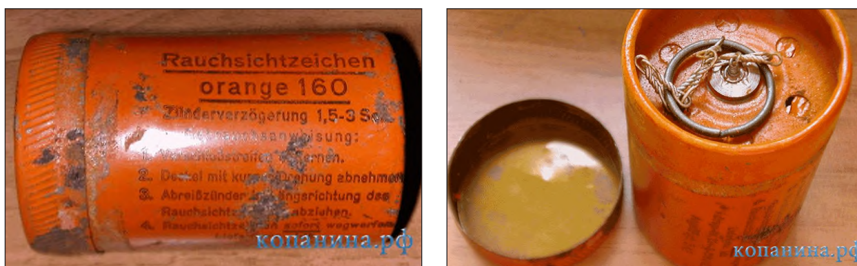
Рисунок 1 – Немецкий дымовой сигнал Rauchsichtzeichen 160 (слева) и немецкая дымовая граната Nebelkerzen Nb.K.39B, основаны на возгоночных пиротехнических составах. Продолжительность дымообразования дымовым сигналом составляет 30–45 с. При благоприятных условиях видимость сигнала и распознаваемость цвета дыма не превышают 1200 м (URL: https://kopateli.cc ; дата обращения: 02.11.2022)
