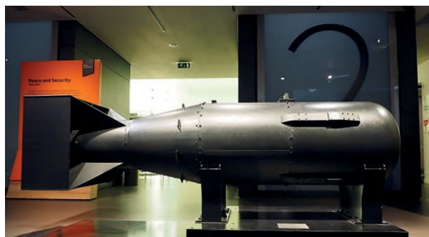
Рисунок 4 – Один из пяти корпусов, изготовленных для бомбы Little Boy, использованной в Хиросиме. Выставлен в Имперском военном музее в Лондоне в 2015 г. Масса бомбы – 4,4 тыс. кг; длина – 3,0 м; диаметр – 71 см. Фотография с сайта: https://en.wikipedia.org/wiki/Little_Boy (дата обращения: 10.08.2023)
