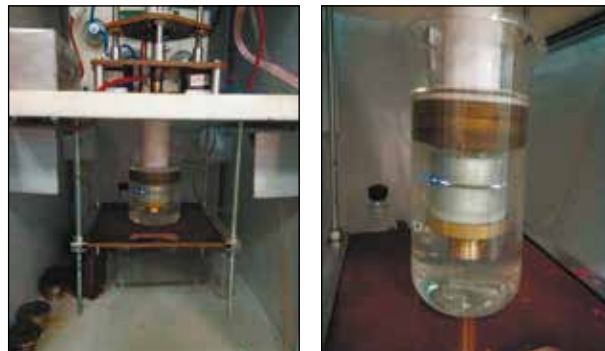
Рисунок 1 – Вид лабораторной установки, на которой получали нанодисперсные системы (фотография авторов)
