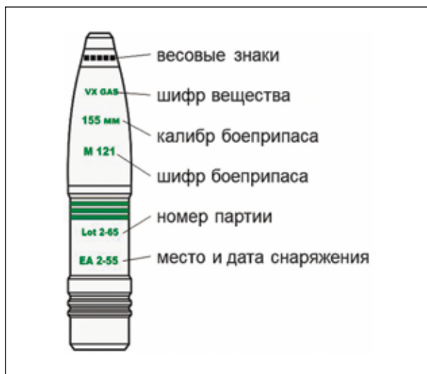
Рисунок 18 – Вариант маркировки артиллерийского химического боеприпаса калибра 155-мм в снаряжении отравляющим веществом типа VX (рисунок авторов)
