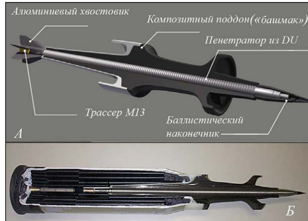
Рисунок 3 – Общая схема БОПС М829 А2 (США). А – схема снаряда. Б – боеприпас в разрезе (URL: https://cezarium.com/wp-content/uploads/2017/04/M829A2.jpg и https://translated.turbopages.org/proxy_u/en-ru.ru.6089afa9-645fe8ec-d3fd4dd9-74722d776562/https/en.wikipedia.org/wiki/M829#/media/File:120mm_M829A2_APFSDS-T.jpg ; дата обращения: 06.01.2023). Сверено с изображениями в книге А.А. Бабкина с соавт. [18]
