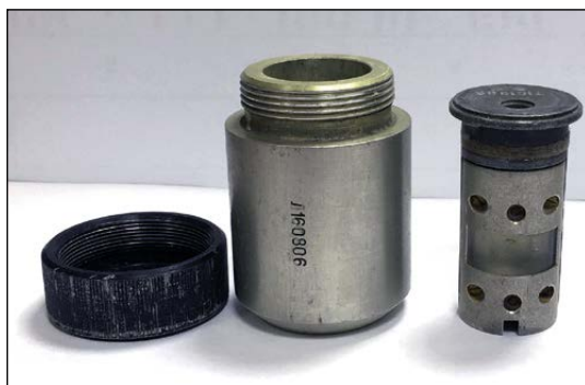
Рисунок 8 – Радиоизотопный градуировочный источник света (с защитным кожухом) (фотография авторов)
