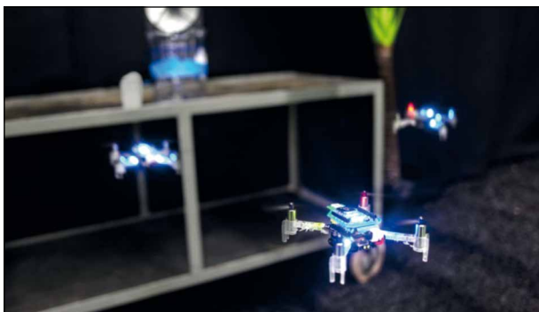
Рисунок 10 – Групповое применение беспилотных летательных аппаратов для нахождения утечки аэрозоля (URL: https://nplus1.ru/news/2021/07/19/drone-gas?ysclid=lb15r0g1mx487705567 ; дата обращения: 06.05.2022)
