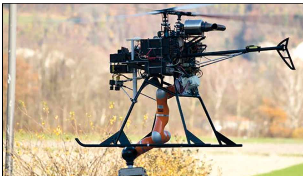
Рисунок 7 – Беспилотный летательный аппарат – синхронтер с роботизированным манипулятором (URL: https://www.dlr.de/content/de/bilder/2016/1/aufnahme-und-transport-eines-mobilen-inspektionsroboters-mit-hilfe-eines-fliegenden-leichtbau-roboterarms-mit-sieben-freiheitsgraden_22187.html ; дата обращения: 05.05.2022)
