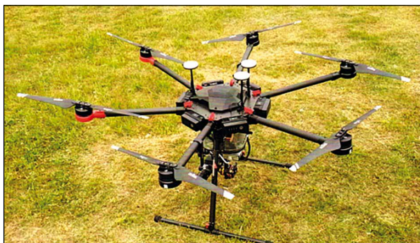
Рисунок 16 – Программно-технический комплекс радиационной и химической разведки на беспилотном летательном аппарате (URL: https://www.burstroy.ru ; дата обращения: 29.04.2022)
