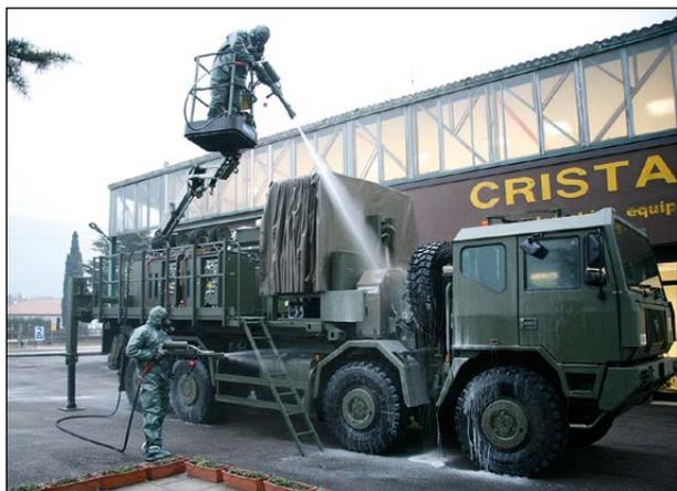
**Рисунок 2 – Внешний вид мобильного комплекса DDMAS. Изображение взято с сайта: URL: <https://www.cristanini.it/eng/products/cbrn-decontamination/decontamination-of-vehicles-materials-terrains-platforms-and-aircrafts/systems/ddmas-decontamination-detoxification-mobile-autonomous-system> (дата обращения: 12.09.2022)**
