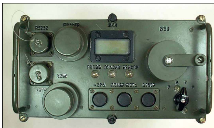
Рисунок 1 – Внешний вид и лицевая панель автоматического газосигнализатора ГСА-5 (фотографии из архива ФГБУ «33 ЦНИИИ» Минобороны России)
