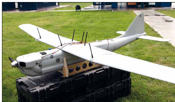
Рисунок 15 – Беспилотный летательный аппарат самолетного типа «Орлан-10» (URL: https://mirtesen.ru/dispute/43901336759/V-Sirishbili-rossiyskiy-BPLA-Orlan-10-?id=comment-reply43901336759 ; дата обращения: 25.04.2022)
