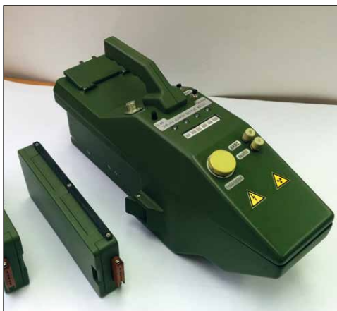
Рисунок 2 – Автоматический газосигнализатор носимый ГС-Н из состава специального оборудования машин РХБ разведки РХМ-8 и РХМ-9 (фотографии из архива ФГБУ «33 ЦНИИИ» Минобороны России)
