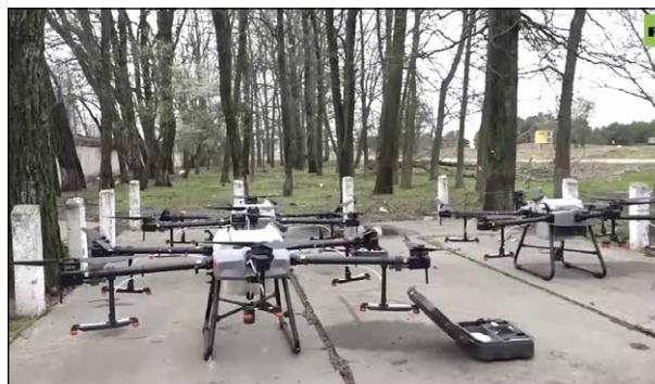
Рисунок 2 – Образцы беспилотных летательных аппаратов, оснащенных емкостями и оборудованием для распыления рецентур (URL: https://smotrim.ru/article/2997393 ; дата обращения: 25.05.2022)
