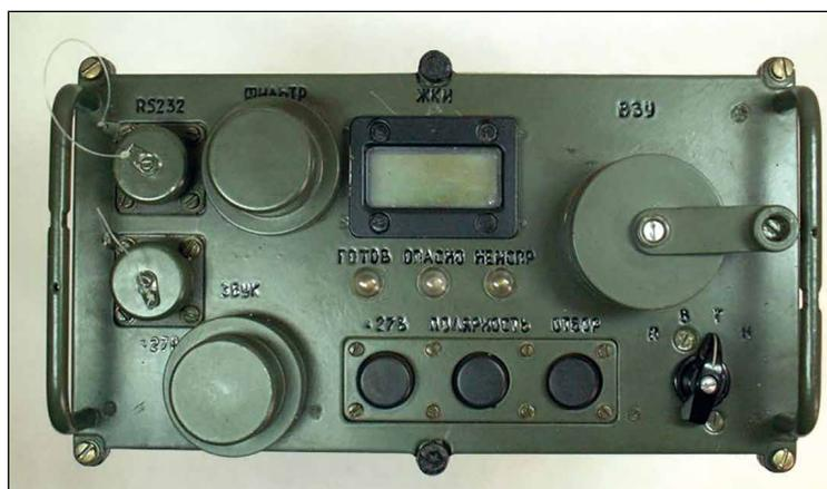
Рисунок 1 – Внешний вид и лицевая панель автоматического газосигнализатора ГСА-5 (фотографии из архива ФГБУ «33 ЦНИИИ» Минобороны России)
