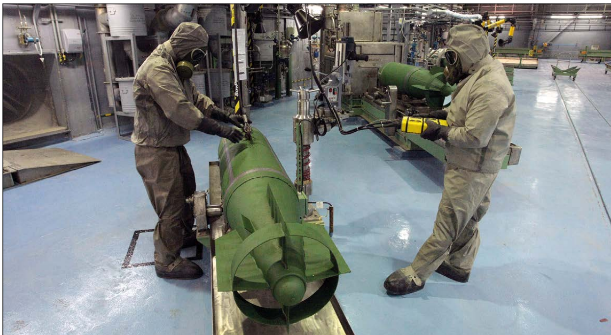
Рисунок 5 – Участок залива реагента в корпуса боеприпасов на объекте по уничтожению химического оружия «Леонидовка» (фотография авторов)
