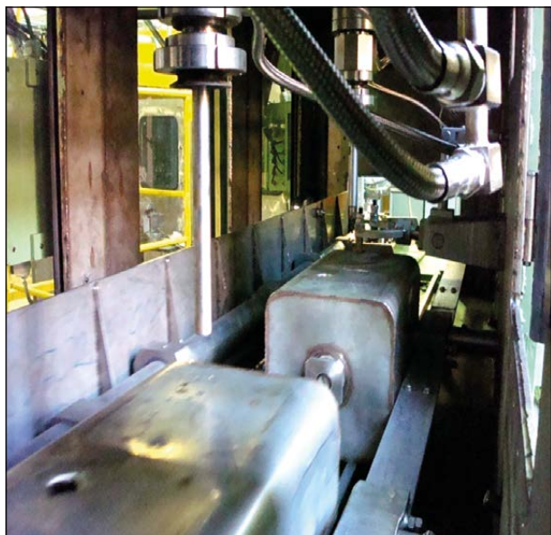
Рисунок 6 – Перемещение модулей боеприпаса 9-А-3264 на рабочую позицию эвакуации ОВ (фотография авторов)
