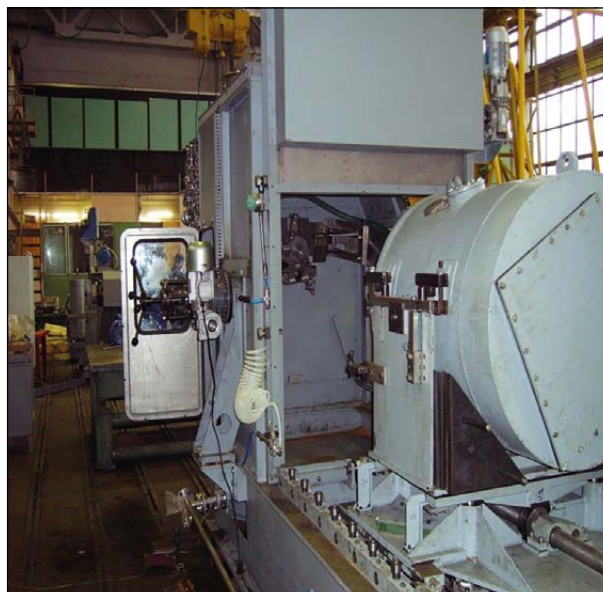
Рисунок 3 – Ложемент с БЧ К-5 на каретке при подаче по конвейеру в технологическую кабину (фотография авторов)
