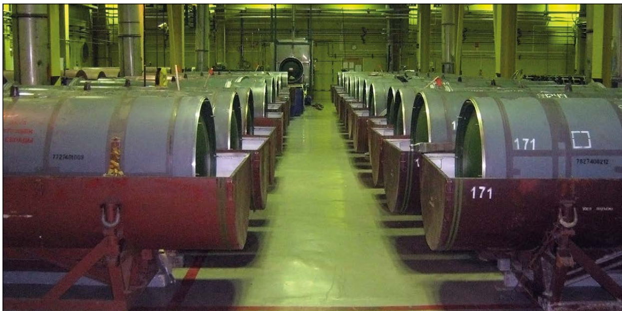
Рисунок 8 – Участок внесения реагента в боеприпасы калибра 2000 кг (фотография авторов)
