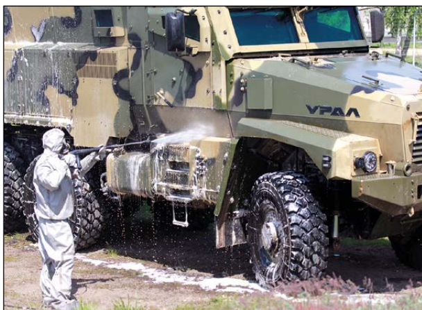
Рисунок 5 – Обработка объекта ВВСТ высоконапорной водяной струей. Авторство изображения принадлежит ФГБУ «33 ЦНИИИ» Минобороны России
