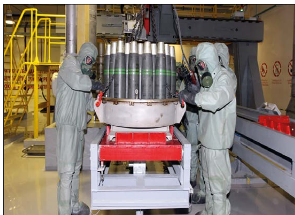
Рисунок 15 – Подготовка к передаче боеприпасов на поточную линию расснаряжения (фотография авторов)
