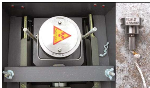
Рисунок 10 – Комплект контрольного источника гамма-излучения КИГИ (фотография авторов)
