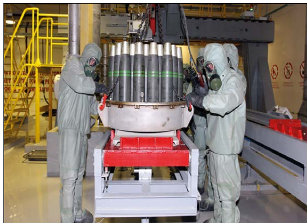
Рисунок 15 – Подготовка к передаче боеприпасов на поточную линию расщепления (фотография авторов)
