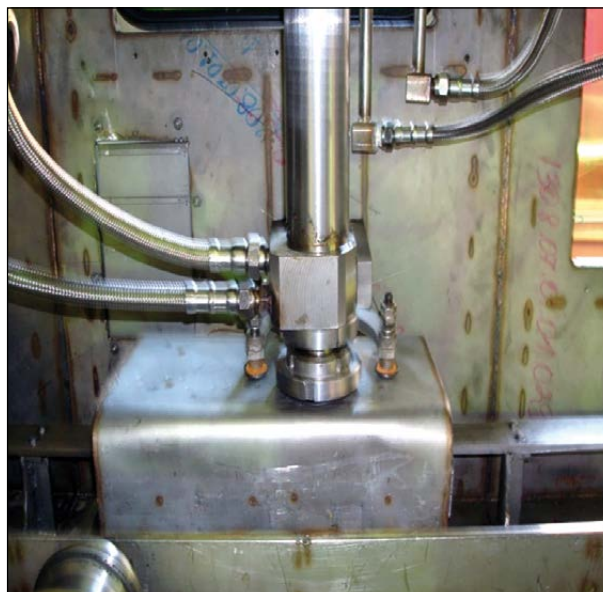
Рисунок 7 – Модуль боеприпаса 9-А-3264 на позиции эвакуации ОВ (фотография авторов)
