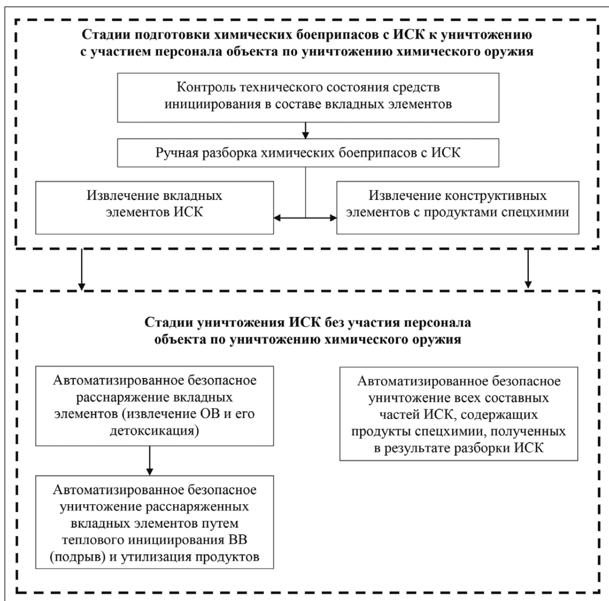
Рисунок 9 – Концепция уничтожения химических боеприпасов с изделиями сложной конструкции. ИСК - изделие сложной конструкции (схема Федерального управления ...)
