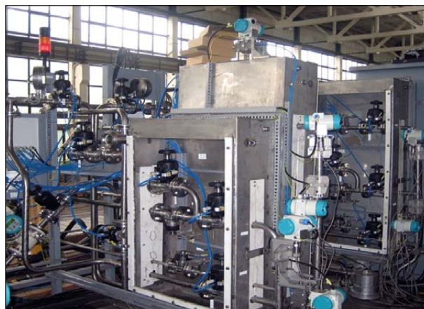
Рисунок 14 – Доработанные блоки технологической обвязки агрегата расщепления (фотография авторов)
