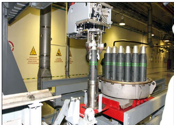
Рисунок 16 – Перегрузка боеприпаса на поточную линию расснаряжения (фотография авторов)
