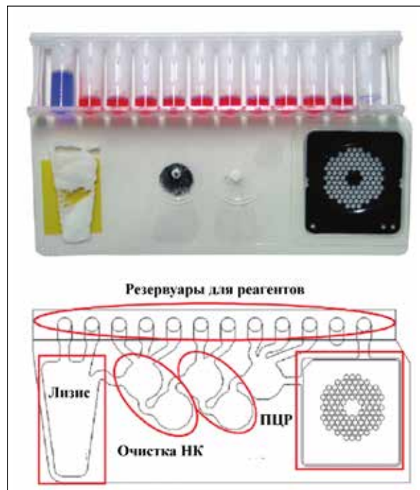
Рисунок 8 – Общий вид и схема функционального предназначения отдельных элементов реакционного пакета «FilmArray» [40]
