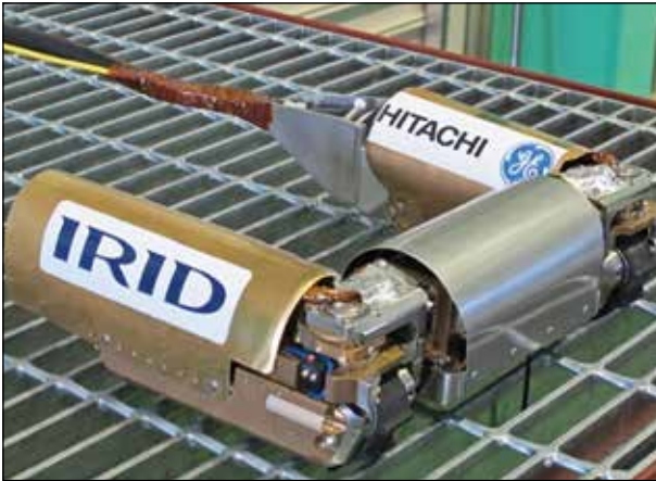
Рисунок 14 – Робототехнический комплекс PMORPH ( https://social-innovation.hitachi/-/media/project/hitachi/sib/ja-jp/case_studies/pmorph_interview/image/hairorobot_02_01.jpg ). Дата обращения: 15.02.2021)
