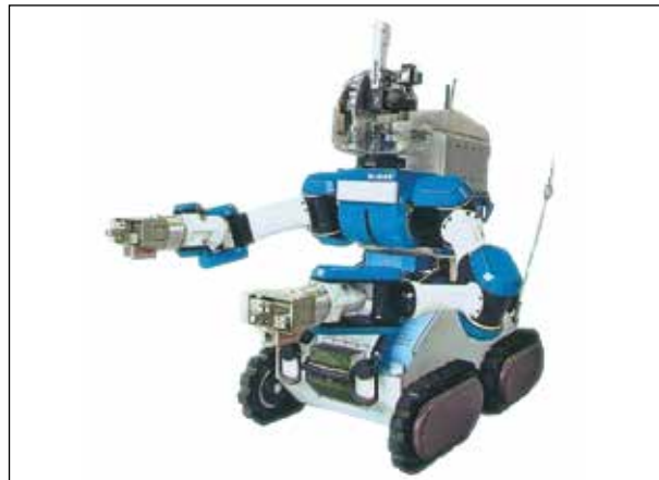
Рисунок 13 – Многоцелевой робототехнический комплекс RaBOT ( https://www.secretprojects.co.uk/data/attachments/53/53306-c4e0aee406158587dd94edc10104a62e.jpg . Дата обращения: 13.02.2021)
