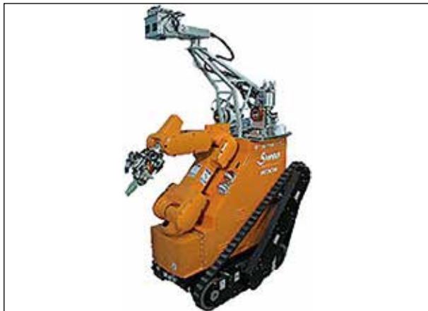
Рисунок 12 – Робототехнический комплекс SWAN ( https://www.secretprojects.co.uk/proxy.php?image=http%3A%2F%2Fwww10.plala.or.jpg Дата обращения: 15.02.2021)
