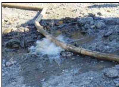
Рисунок 6 – Повреждения рукавов, насосов и других металлических и резиновых изделий, используемых при перекачке хлорсиланов (октябрь 2020 г., фотографии авторов)
