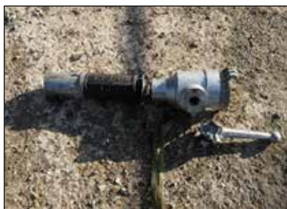
Рисунок 6 – Повреждения рукавов, насосов и других металлических и резиновых изделий, используемых при перекачке хлорсиланов (октябрь 2020 г., фотографии авторов)
