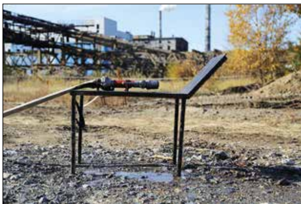
Рисунок 10 – Вспомогательный стол и выставляемая с его помощью щелочная завеса (октябрь 2020 г., фотографии авторов)
