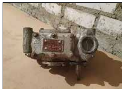
Рисунок 6 – Повреждения рукавов, насосов и других металлических и резиновых изделий, используемых при перекачке хлорсиланов (октябрь 2020 г., фотографии авторов)
