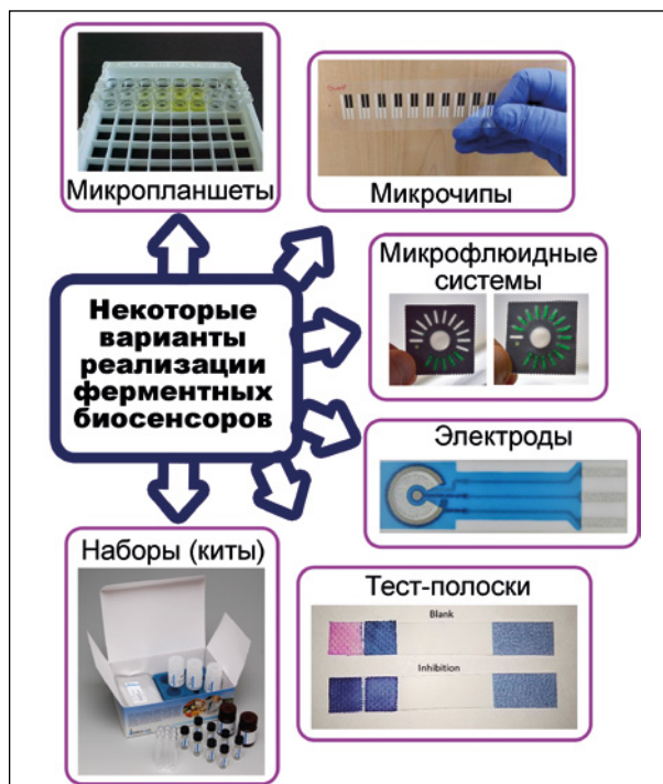
Рисунок 1 – Примеры некоторых биоаналитических систем на основе ферментов для определения ФОС (схема авторов, составлена на основе рисунков и фотографий, находящихся в свободном доступе в сети «Интернет»)
