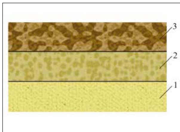
Рисунок 3 – Схема структуры комплектов защитной одежды с применением материала типа Саратога [15] (1 – подкладочный слой (подкладка) из нейлонового трикотажа; 2 – внутренний (средний) слой из пенополиуретана с равномерно фиксированными на нем частицами АУ; 3 – наружный слой (камуфляж))
