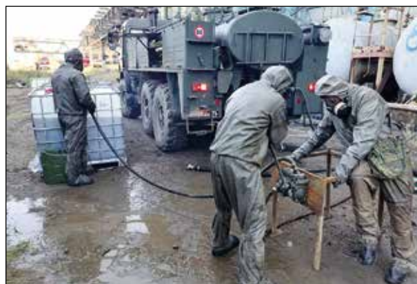
Рисунок 5 – Перетаривание специалистами войск РХБ защиты токсичных веществ насосами БКФ, расположенными на специальных станинах (октябрь 2020 г., фотографии авторов)
