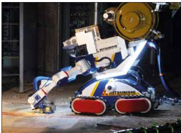
Рисунок 16 – Многофункциональный робототехнический комплекс MEISTeR ( https://irid.or.jp/common/img/meister/2.jpg ). Дата обращения: 15.02.2021)
