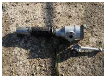
Рисунок 6 – Повреждения рукавов, насосов и других металлических и резинотехнических изделий, используемых при перекачке хлорсиланов (октябрь 2020 г., фотографии авторов)
