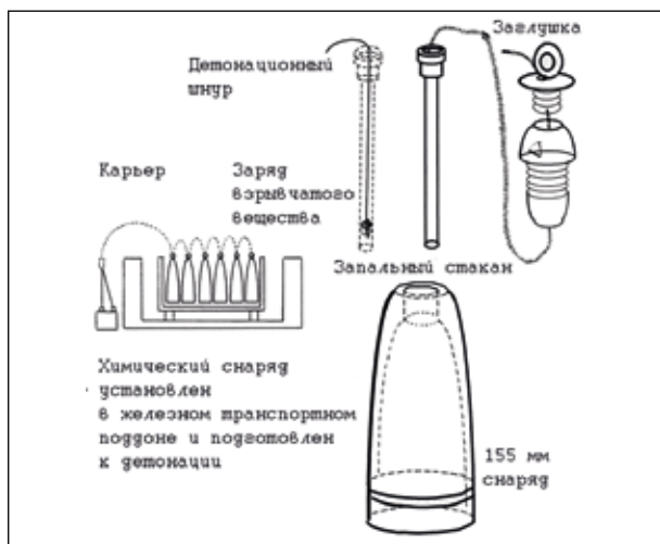
Рисунок 17 – Схема подготовки 155-мм химического снаряда к откачке ОВ [29]
