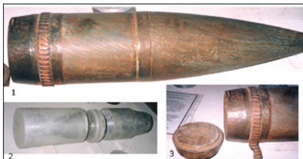
Рисунок 7 – Бинарный 152-мм зариновый снаряд на основе осветительного снаряда с вышибным дном. 1. Внешний вид снаряда. Алюминиевые контейнеры с прекурсорами. 3. Вышибное дно [5]
